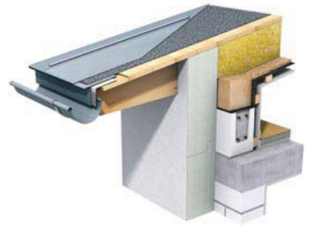
Fig. 2: Ikke ventilert takkonstruksjon med strukturmatte
