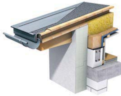
Fig. 1: Ventilert takkonstruksjon med strukturmatte
